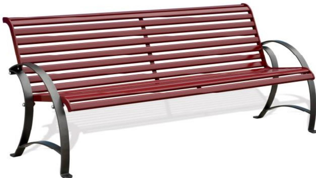
**STRUTTURA** Panchina Artemide composta da n. 2 supporti in ferro piatto zincato da mm. 50x8 che formano due arcate asimmetriche collegate tra loro da un archetto inferiore. I supporti sono dotati alla base di fori per l'ancoraggio al suolo. Scocca seduta-schienale realizzata con 17 profili in tubo di acciaio zincato a sezione ovale da mm. 40x20x1,5. I profili sono saldati su apposite sagome in acciaio zincato che ne conferiscono la forma anatomica.
