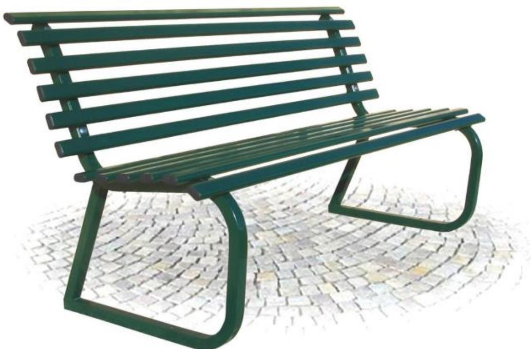
Struttura: Panchina composta da n. 2 supporti in tubolare d'acciaio quadrato sezione mm. 30 x 30. Seduta e schienale composte da due pannelli realizzati mediante doghe in tubolare ovale d'acciaio sezione mm. 40 x 20 dotati di copritesta alettato in PE di colore nero unite tra loro da profili in acciaio.
