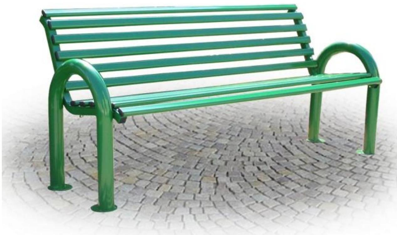
Struttura: Panchina composta da n. 2 supporti realizzati in tubo tondo d'acciaio zincato Ø mm. 60x2 piegati ad "U" capovolta dotati di piastre per l'ancoraggio al suolo. Seduta e schienale della lunghezza di cm 150 realizzati mediante doghe in tubolare ovale d'acciaio sezione mm. 40 x 20 x 1,5 dotati di copritesta alettato in PE di colore nero.
