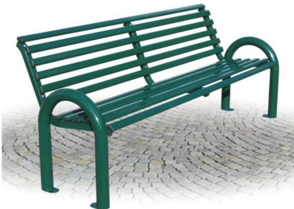
Struttura: Panchina composta da n. 2 supporti realizzati in tubo tondo d'acciaio zincato Ø mm. 60x2 piegati ad "U" capovolta dotati di piastre per l'ancoraggio al suolo. Seduta e schienale della lunghezza di cm 200 realizzati mediante doghe in tubolare ovale d'acciaio sezione mm. 40 x 20 x 1,5 dotati di copritesta alettato in PE di colore nero.
