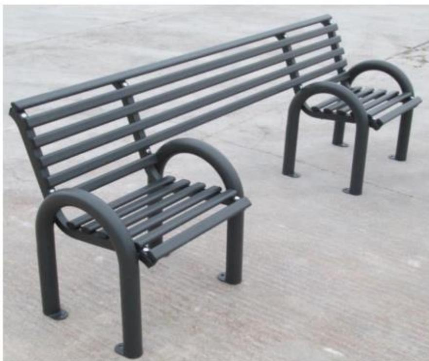
Struttura: Panchina composta da supporti realizzati in tubo tondo d'acciaio zincato  $\varnothing$  mm. 60x2 piegati ad "U" capovolta dotati di piastre per l'ancoraggio al suolo. Seduta e schienale realizzati mediante doghe in tubolare ovale d'acciaio sezione mm. 40 x 20 dotati di copritesta alettato in PE di colore nero. Al centro della panchina è ricavato uno spazio provvisto solo di schienale ove inserita targa con logo "riservato disabili".
