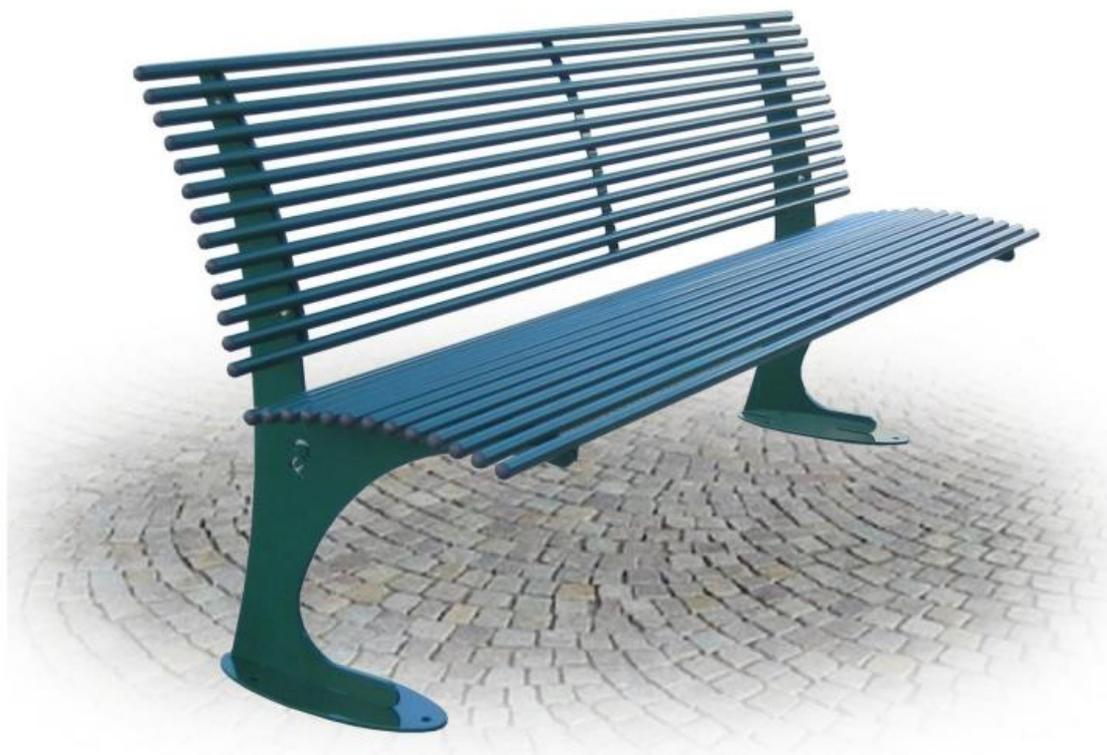
Struttura: Panchina composta da due supporti in lamiera sagomata con tecnologia laser sp. 60/10. Seduta e schienale realizzati in tubo tondo d'acciaio zincato Ø mm. 20x15/10 di spessore, con all'estremità puntali copritesta a testa sferica alettati in PE colore nero.
