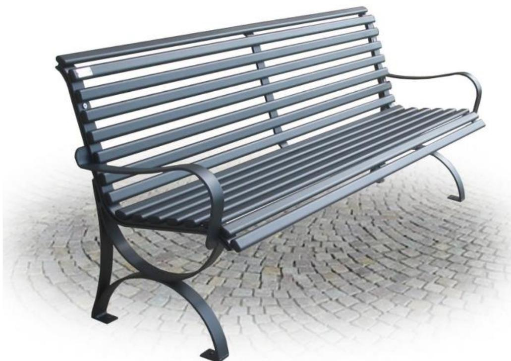
Struttura: Panchina composta da 2 supporti con bracciolo realizzati in ferro piatto zincato mm. 50x8. Seduta anatomica realizzata mediante doghe in tubolare ovale d'acciaio zincato sezione mm. 40 x 20 lunghezza cm 200 dotate di copritesta alettato in P.E.
