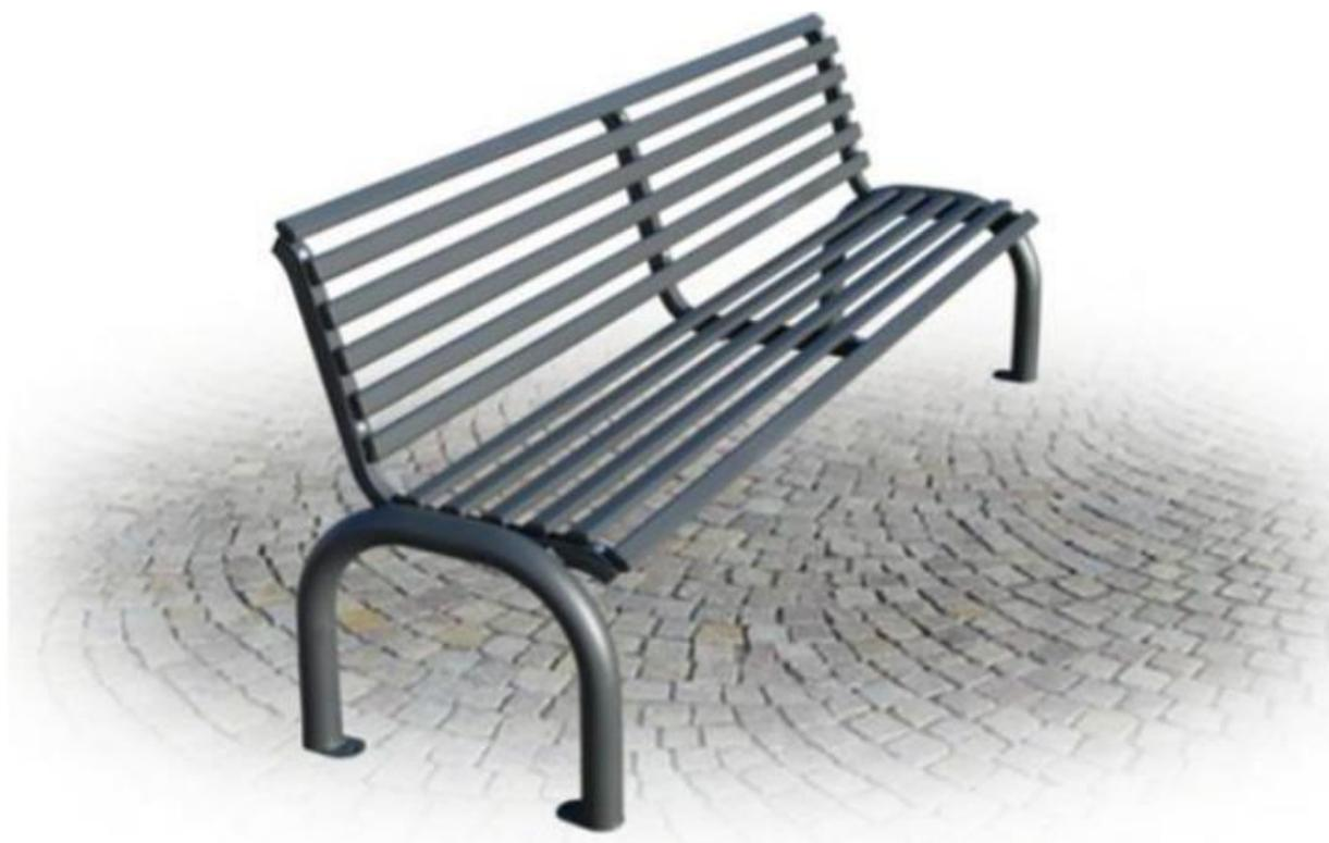
Struttura: Panchina composta da n. 2 supporti realizzati in tubo tondo d'acciaio zincato Sendzimir Ø mm. 60x2 piegati ad "U" capovolta dotati di piastre per l'ancoraggio al suolo. Seduta e schienale della lunghezza di cm 200 realizzati mediante doghe in tubolare ovale d'acciaio zincato Sendzimir sezione mm. 40 x 20 x 1,5 dotati di copritesta alettato in PE di colore nero.
